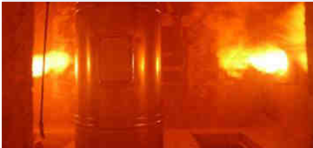
Ensaio de resistência ao fogo
