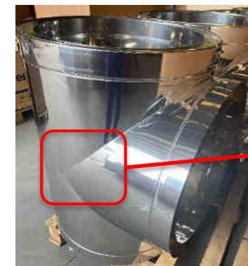
Saldatura completa di tutti i componenti
